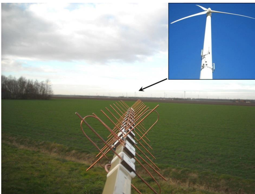
Figuur H.4: De kruisyagi (+/- parallax) gericht op een LTE-mast in een windmolen op een meetlocatie. (Foto's: R. den Besten)
